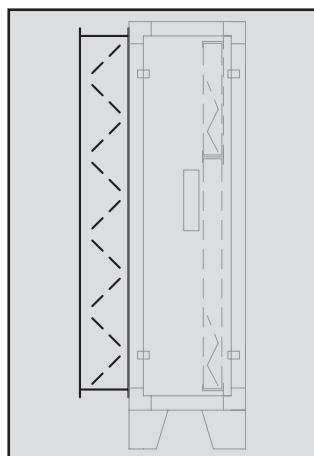
Serranda di taratura avente dimensioni pari alla sezione frontale dell'unità, realizzata in alluminio estruso Anticorodal con alette aventi sagomatura a profilo alare e guarnizione di tenuta.
