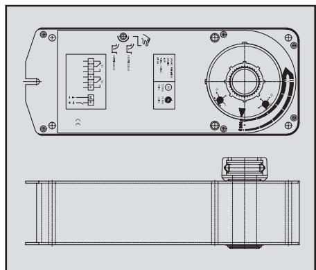
Comando On/Off con ritorno a molla. Il servomotore apre la serranda caricando la molla di ritorno: in mancanza di corrente la serranda viene riportata alla posizione di sicurezza dalla molla. Per sezioni di miscela e di recupero dev'essere previsto un servomotore per ciascuna serranda.
