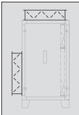
Serranda di taratura dimensionata per il 100% della portata d'aria, realizzata in alluminio estruso Anticorodal con alette aventi sagomatura a profilo alare e guarnizione di tenuta.
