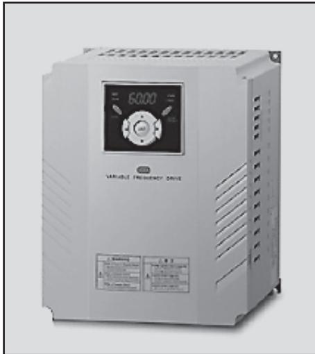
L'inverter di cui sono dotate di serie le sezioni ventilanti permette di variare le prestazioni del ventilatore in base alle richieste di portata aria e prevalenza, garantendo in tal modo un'ampia flessibilità di utilizzo e, grazie al controllo PID di cui è dotato, si adatta automaticamente ai possibili cambiamenti delle condizioni di utilizzo, quali ad esempio l'incremento delle perdite di carico dovuto al progressivo sporcamento dei filtri.
